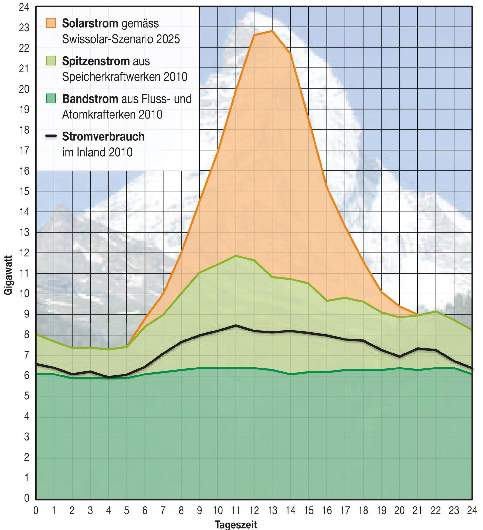
Die Grafik zeigt die heutige Produktion von Band- und Spitzenstrom an einem typischen Werktag im Juli plus modellhaft die maximal mögliche Spitzenproduktion von Solarstrom an einem Julitag im Jahr 2025, wenn in der ganzen Schweiz die Sonne scheint. Diese theoretische Produktionsspitze lässt sich mit verändertem Betrieb der Speicherkraftwerke und weiteren Massnahmen dem Verbrauch angleichen.
